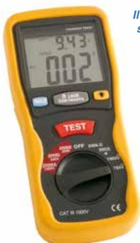
*Il test di isolamento elettrico è uno dei parametri importanti che deve essere eseguito a garanzia delle norme sulla sicurezza elettrica, il misuratore ARW-5500 è uno strumento semplice e compatto per l'utilizzo delle verifiche di impianti elettrici con una portata massima di 2000 MegaOhm e risoluzione minima 0,1 MΩ (4000 MΩ e risoluzione minima 0,01 MΩ per modello ARW-5505 Kit di forniture: 6 batterie 1.5V AA, puntali di misura, valigetta in ABS e manuale d'uso*
