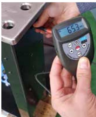
**Ideale per qualsiasi tipo di rivestimento (vernice, plastica, zinco, cromo, gomma, ceramica, ecc.) su basi metalliche magnetiche "FE" (versioni 826 F - 826 FN), la versione 826 FN consente inoltre di misurare rivestimenti (vernice, plastica, anodizzazione, cromo, gomma, ceramica, ecc.) su basi metalliche amagnetiche "NFE".**
